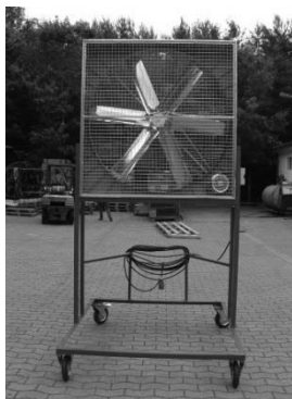
Beispiel eines mobilen Stützluftventilators
