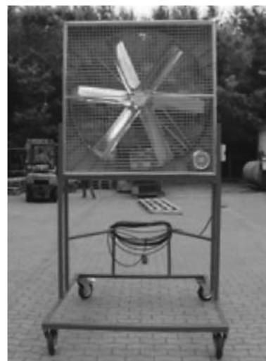
*Beispiel eines mobilen Stützluftventilators*
