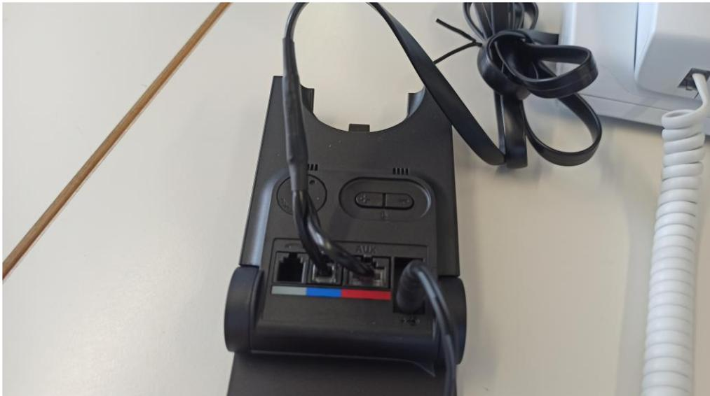
Möglicherweise ist das Headset noch nicht sofort einsatzbereit. Es kann sein, dass bis zu 20 Minuten für eine Akku-Ladung benötigt werden. Spätestens danach sollte das Gerät funktionieren.
