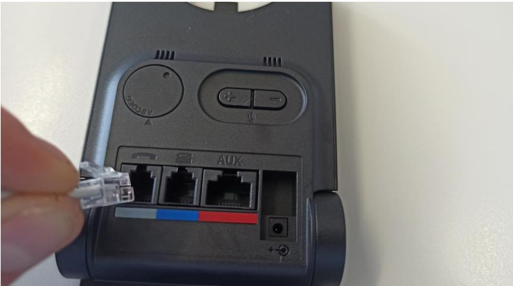
3. Nehmen Sie das mitgelieferte Telefonkabel aus der Verpackung. Stecken Sie das Ende mit dem blauen Ring in den blauen Anschluss der Basisstation.
