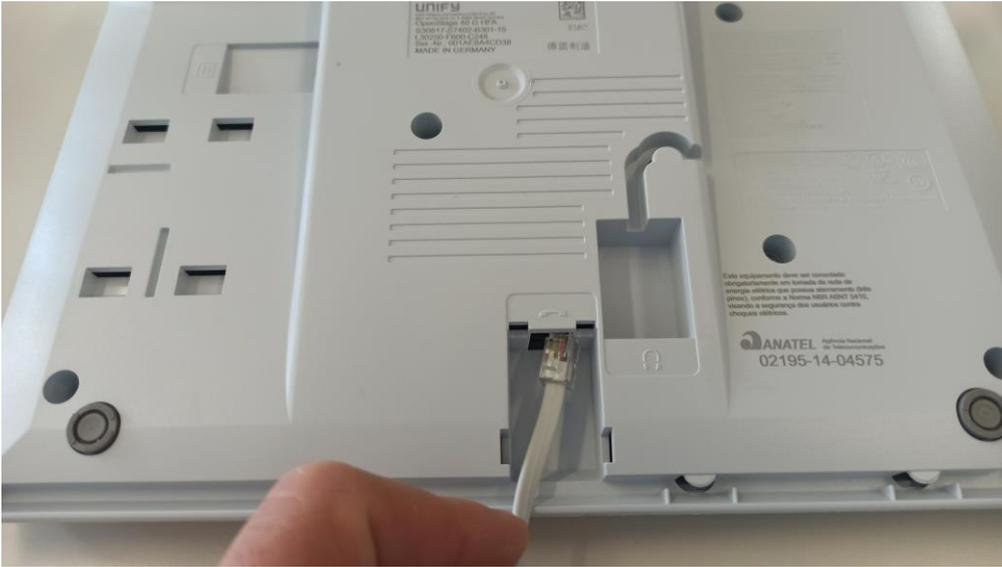
2. Stecken Sie das Hörer-Kabel in den grauen Anschluss der Basis-Station ein.
