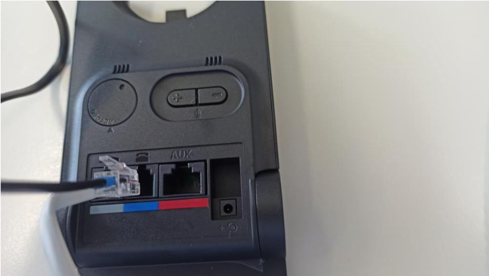
4. Stecken Sie das andere Ende des Telefonkabels in den Anschluss Ihres Telefons, aus dem Sie gerade das Hörer-Kabel herausgezogen haben.
