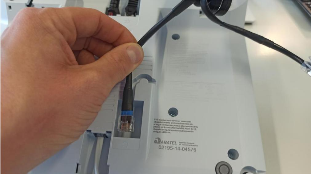
2. Nehmen Sie das Ende des DHSG-Kabels, an dem sich zwei Stecker befinden. Nehmen Sie auf dieser Seite den schmaleren der beiden Anschlüsse. Stecken Sie diesen in den blauen Anschluss der Basis-Station des Headsets ein.
