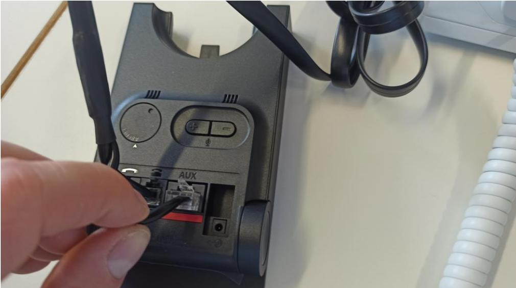
4. Stecken Sie nun das Netzkabel in den runden Anschluss der Basis-Station ein. Verbinden Sie das Netzteil nun mit dem Stromnetz.
