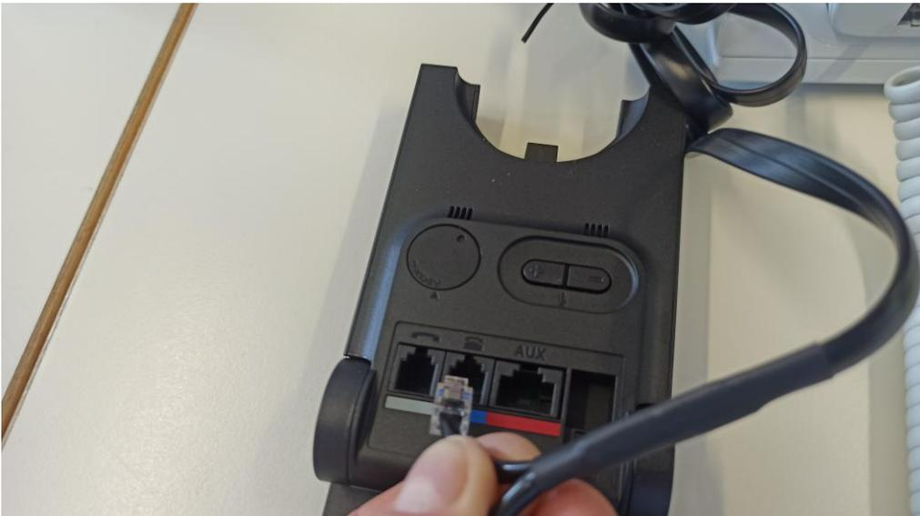
3. Nehmen Sie den verbliebenen Anschluss des DMSG-Kabels. Stecken Sie diesen in den roten Anschluss der Basis-Station.
