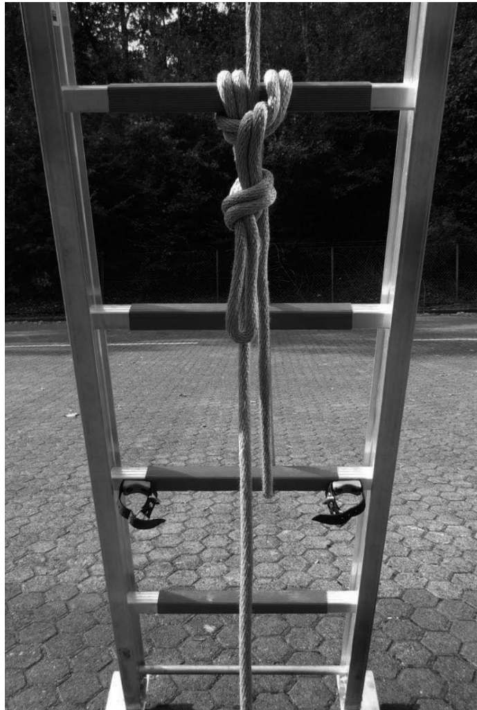
Abbildung 24: Sichern des Zugseils mit Mastwurf und Spierenstich
