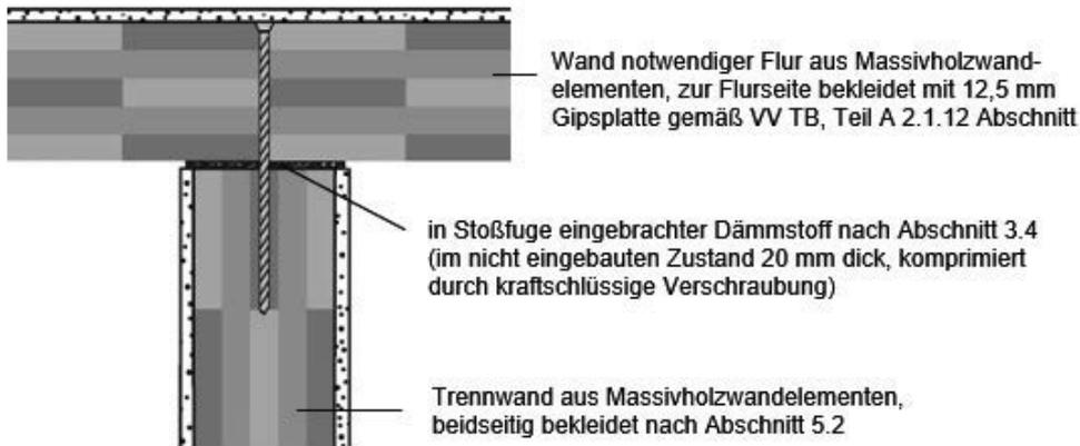
Prinzipskizze 8b: Anschluss Trennwand/Wand notwendiger Flur, Bauteilfuge (Horizontalschnitt)
