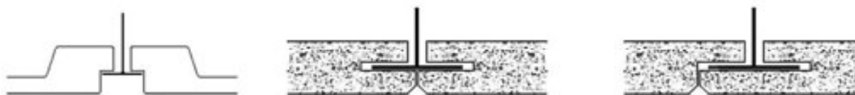
Bild 6 — Beispiele für mögliche Ausführungen von Unterdecken mit verschiedenen Kantenformen
