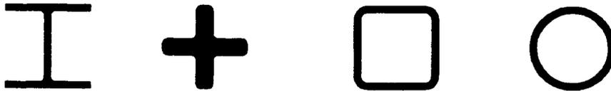
d) Beispiele für Querschnitte von Stahlpfählen
