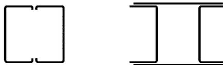
c) Geschlossene, zusammengesetzte Querschnitte
